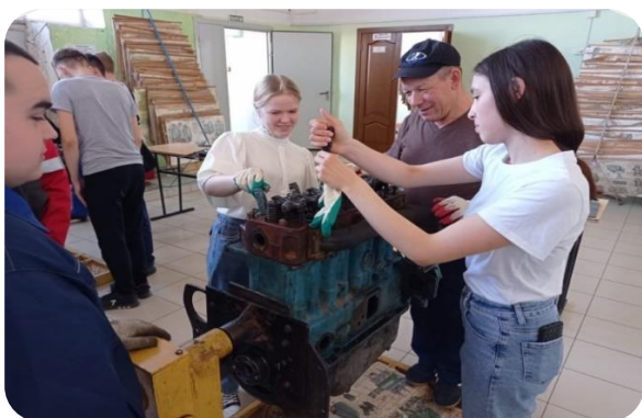
Рисунок 2. Фотография учеников 9 класса, настраивающих газораспределительный механизм
