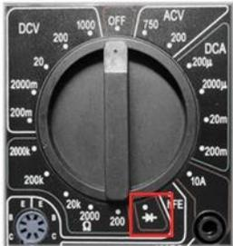
В данном режиме, на мультиметре отображается прямое напряжение.
