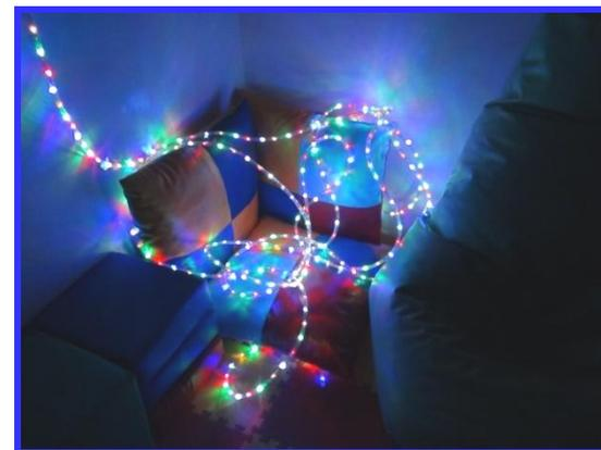
Это прозрачный (цветной) шнур с расположенными внутри лампами накаливания или светодиодами. Изготовлен из гибких полимеров, выполняет функции световой гирлянды. Переключение цветовых режимов осуществляется при помощи контроллера.
