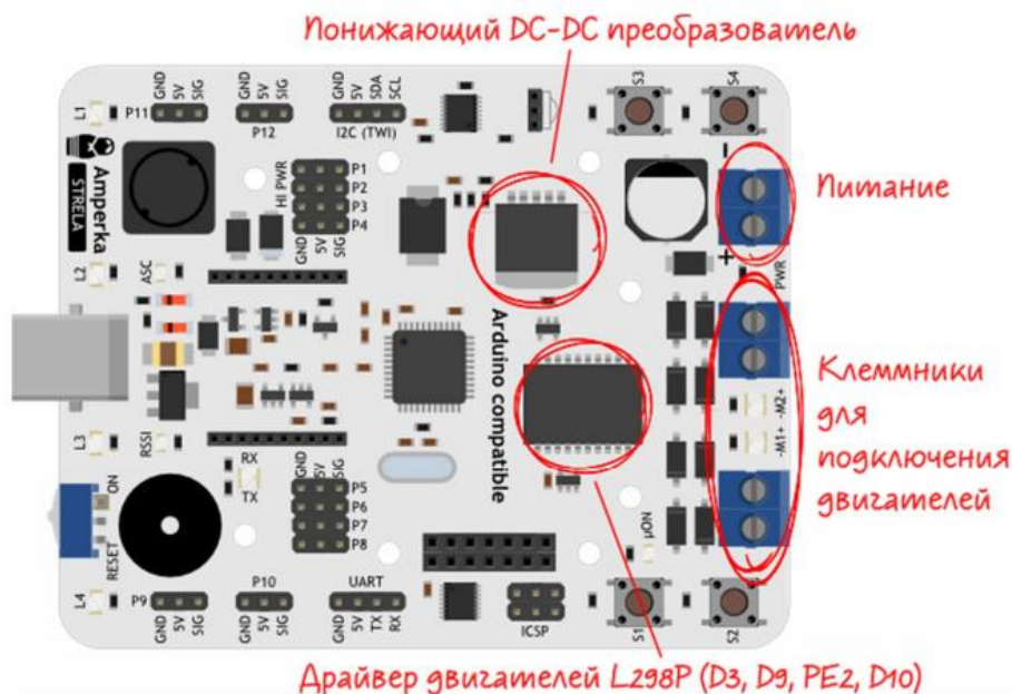
Рис. 5. Драйвер двигателей и понижающий преобразователь.
