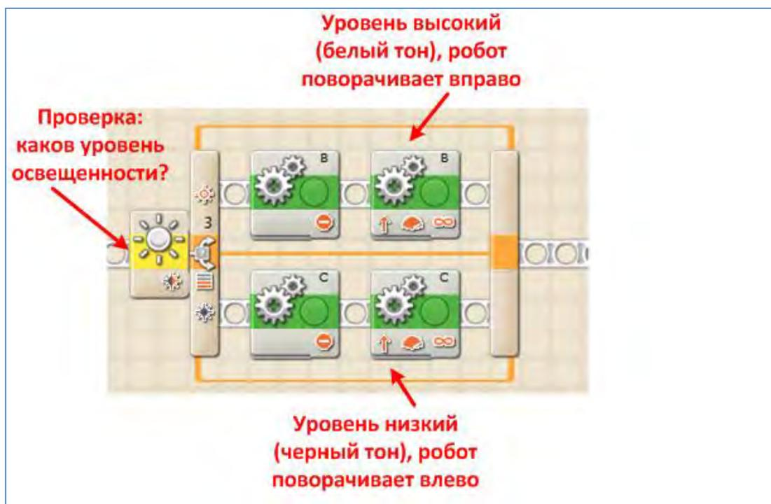
Рисунок 9. Алгоритм реакции на уровень освещенности
