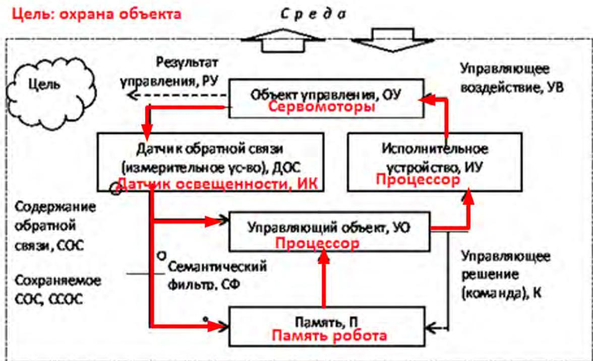
Рисунок 7. Система управления роботом-охранником
