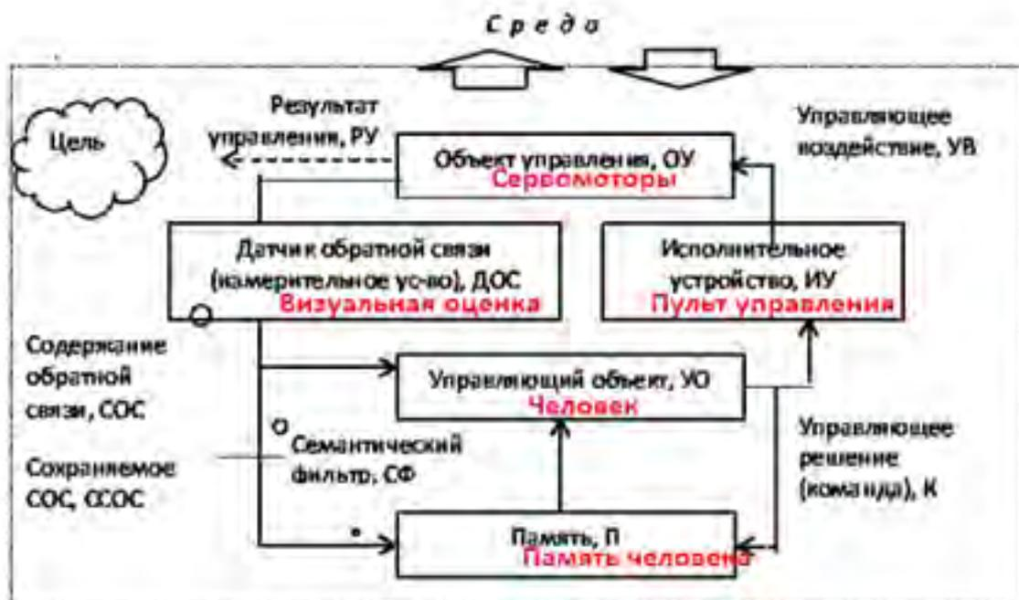
Рисунок 2. Обобщенная схема системы управления в случае управления роботом человеком
