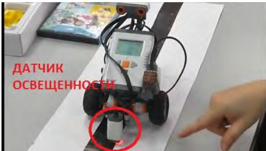
Рисунок 8. Датчик освещенности робота
